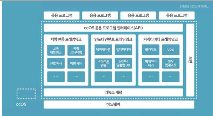
그림9 현대차 ccOS의 구성: 리눅스 기반 자체 인포테인먼트 플랫폼 적용 시작
